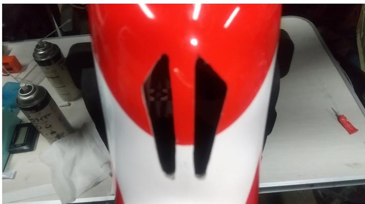
■付属のテンプレートを利用して、胴体とフロントのエアインテークをマーキングし、穴を開けて下さい。
