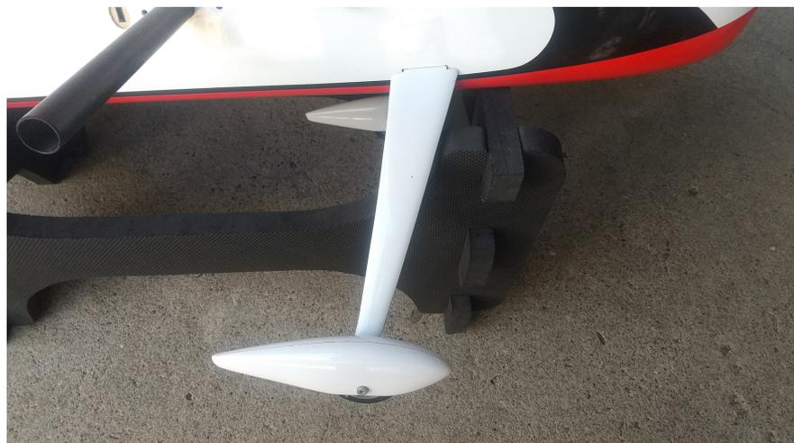
■ 脚固定は上面から付属の2本のボルトで固定します。取り付け前に取付穴の周辺を、瞬間接着剤(低粘度)を染み込ませ固めておきます。稀に穴に接着剤がはみ出していることがありますので、丸ヤスリ等で削り合わせて、取付けて下さい。
