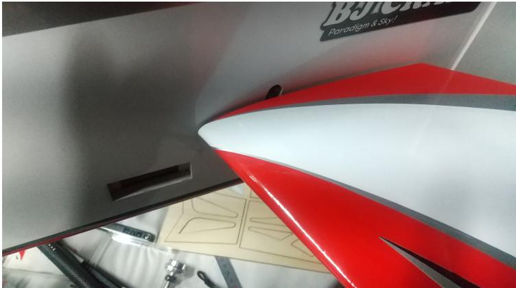
■ 水平尾翼のセンターパイプ(外パイプ)の入り口をリューターにて広げ、水平尾翼がスムーズに動く程度にほんの少しだけ広げます。
