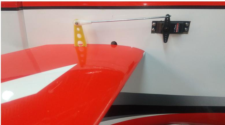
■ホーンにボールアジャスターを取り付けます。固定後はナット側に速乾の瞬間接着剤(低粘度)を塗り緩み止めを行ってください。
