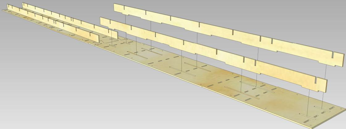
Collez sur le dessous de la platine servos **PS pl n°4** (la gravure vous indiquera le dessus) deux morceaux de pin 10x3mm.
