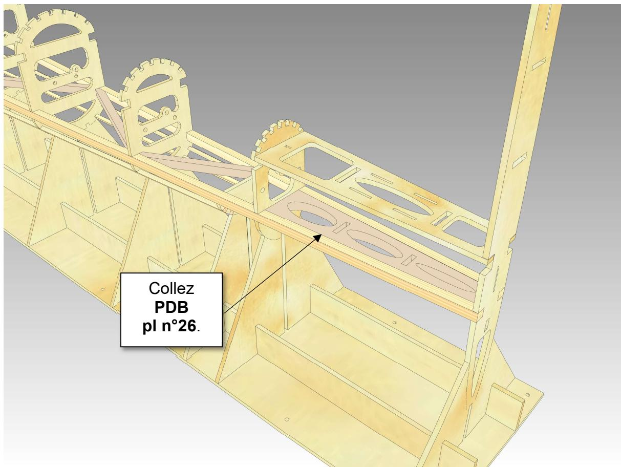
Recommencez la même opération pour les baguettes en pin 6x6mm constituant la partie supérieure du flanc.
