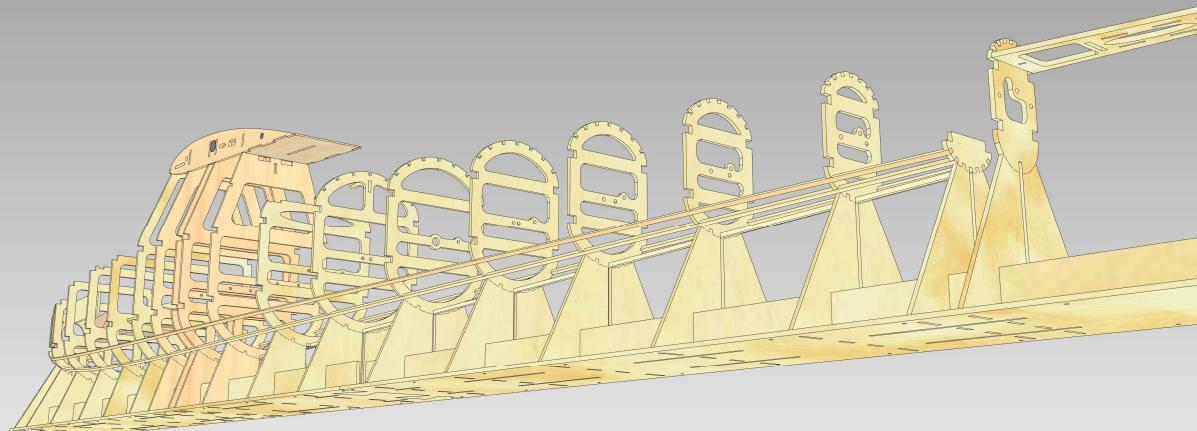
Vous collerez les baguettes se trouvant au niveau des jambettes de couple une fois le fuselage détaché de son chantier.
