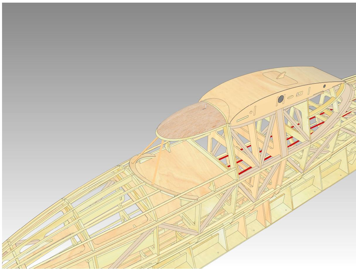
Découpez dans le rond en hêtre 3mm fourni dans le kit deux longueurs de 12mm puis collez-les aux cercles en CTP 3mm **pl n°2** se trouvant à côté de CC6.
