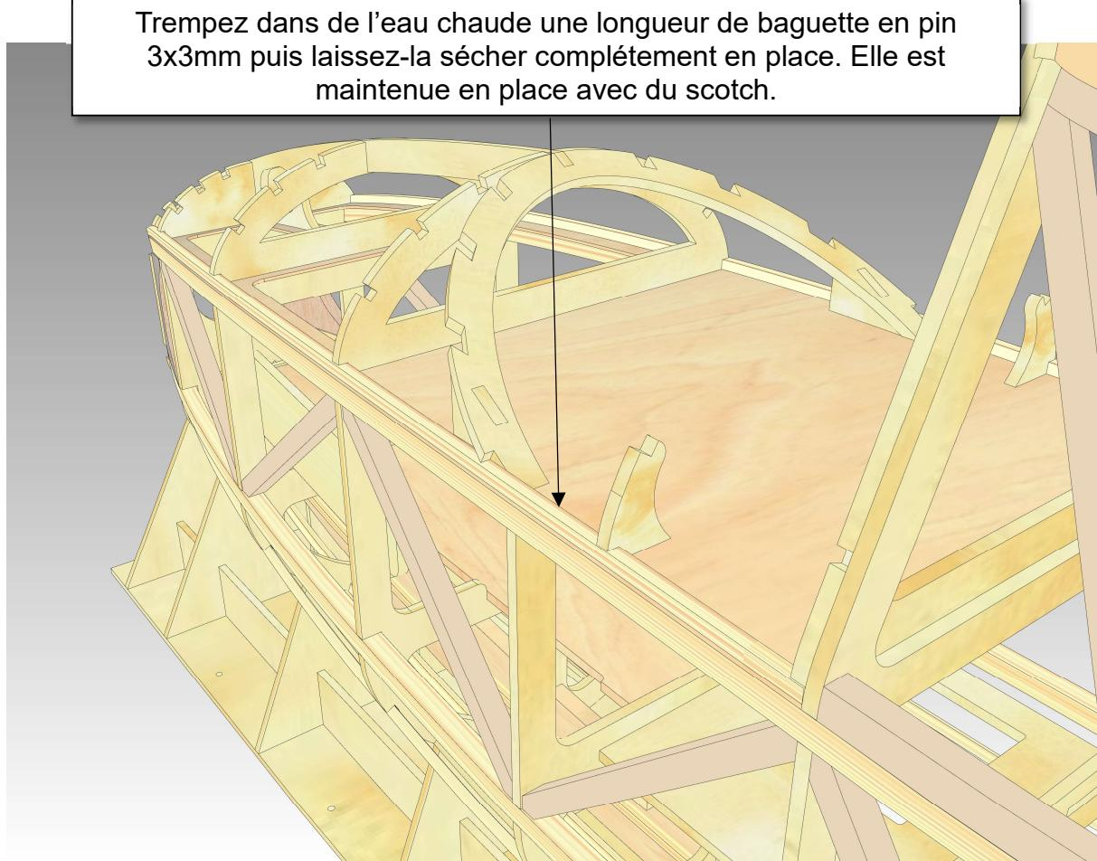
Faites de même avec les autres baguettes en pin 3x3mm. Une fois sèches, collez-les sur les couples de la cabine.
