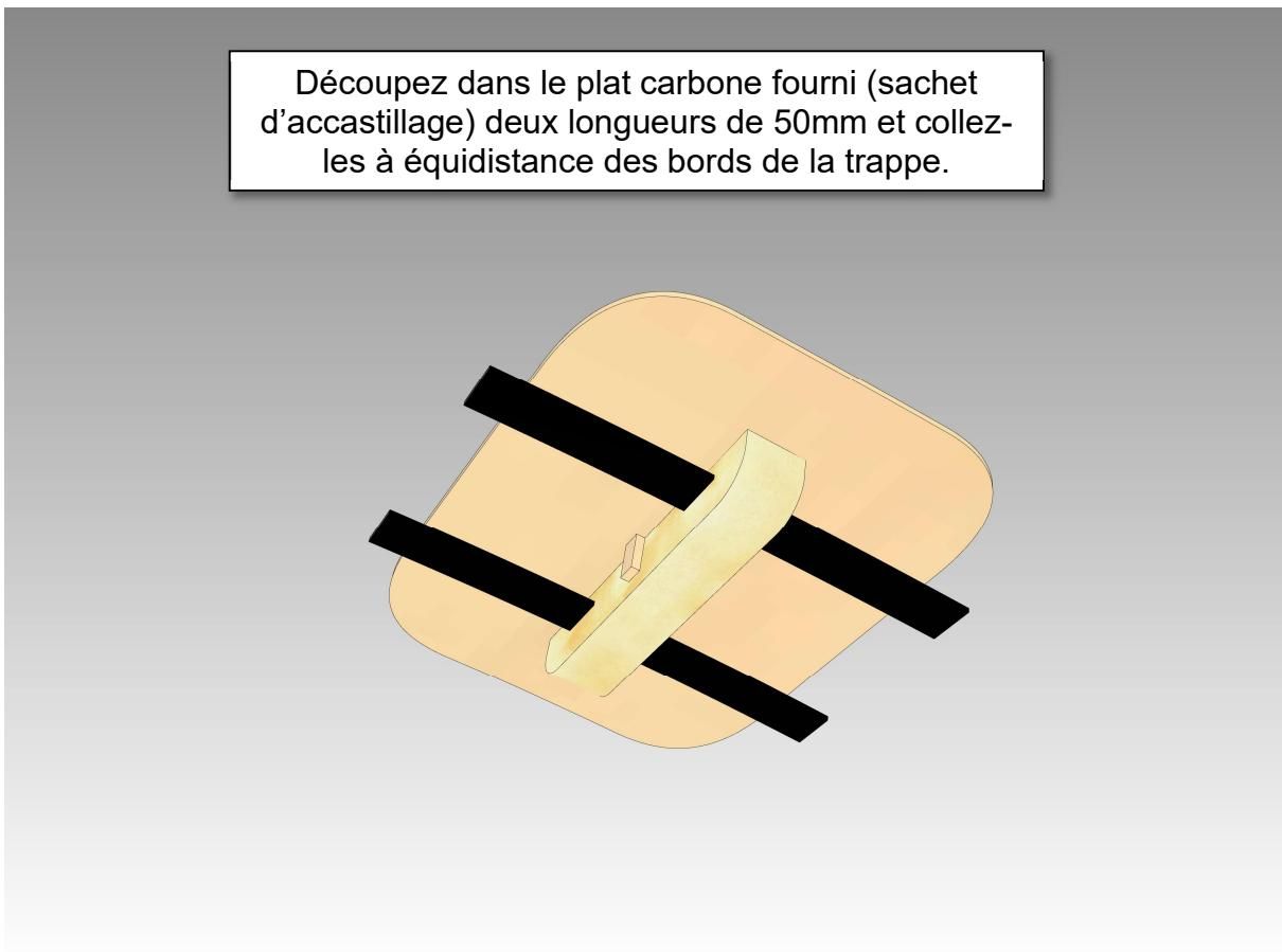
Découpez dans le plat carbone fourni (sachet d'accastillage) deux longueurs de 50mm et collez-les à équidistance des bords de la trappe.
