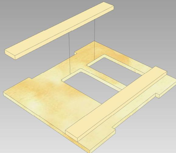
Positionnez sur le chantier les couples suivants. Collez-les sur le chantier en faisant infiltrer un de peu de colle cyano aux niveaux des encastrements. **Leurs gravures (C1, C3 etc..) doivent faire face à l'avant.**
