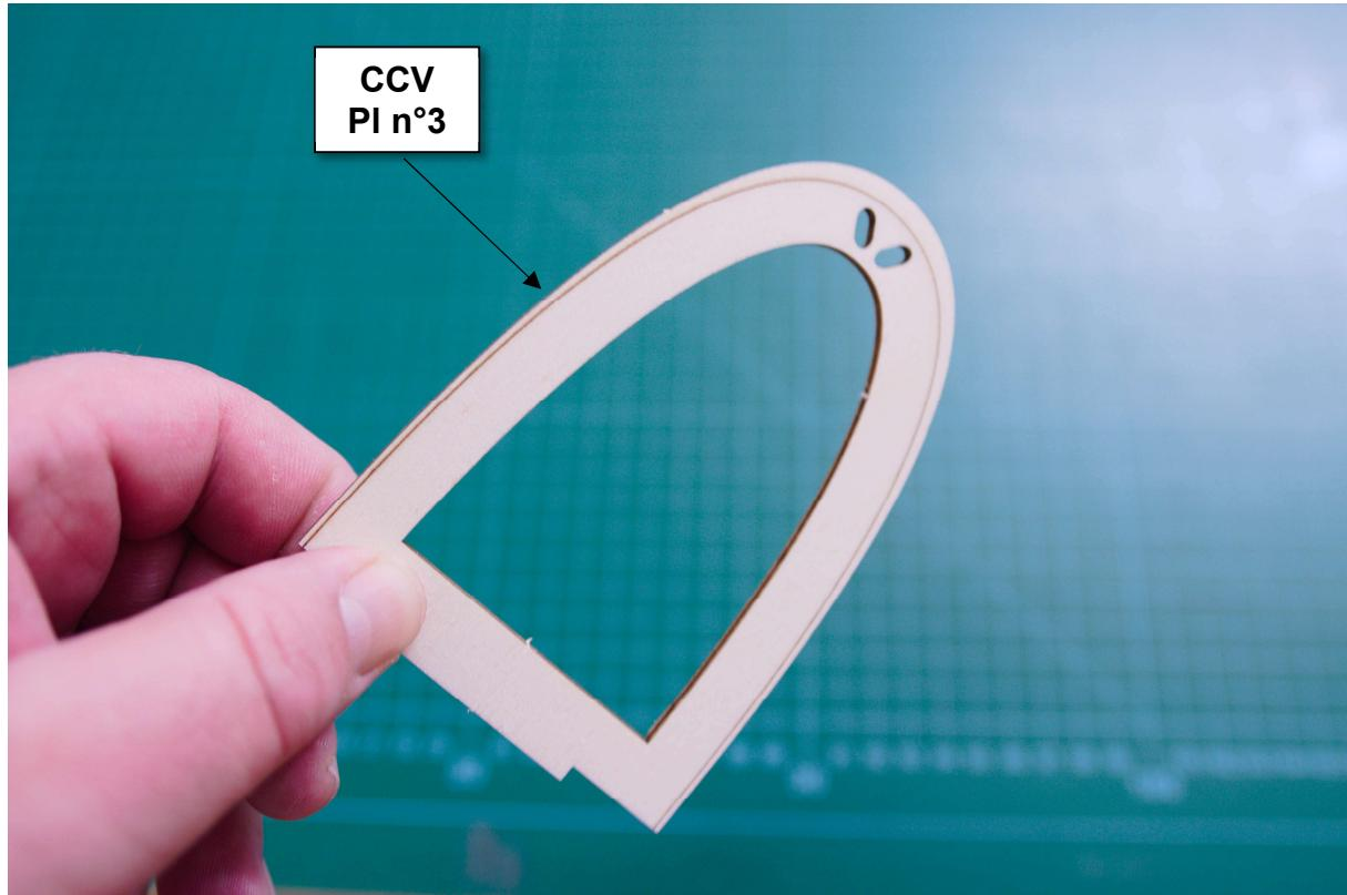
Poncez les bords de la pièce en biseau à l'aide du guide de ponçage gravé au laser.
